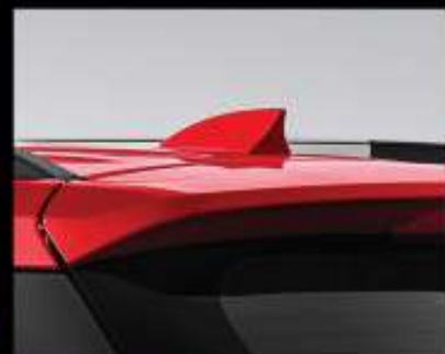
Shark Fin Antenna Memperkuat penerimaan sinyal radio dengan desain yang futuristik.
