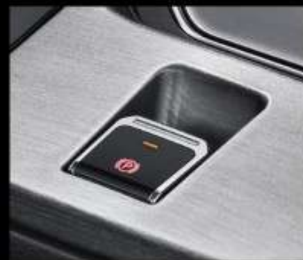
EPB (Electric Parking Brake) Rem parkir elektrik yang canggih memberikan kemudahan dan kenyamanan bagi pengemudi hanya dengan satu sentuhan tanpa perlu menarik tuas.
