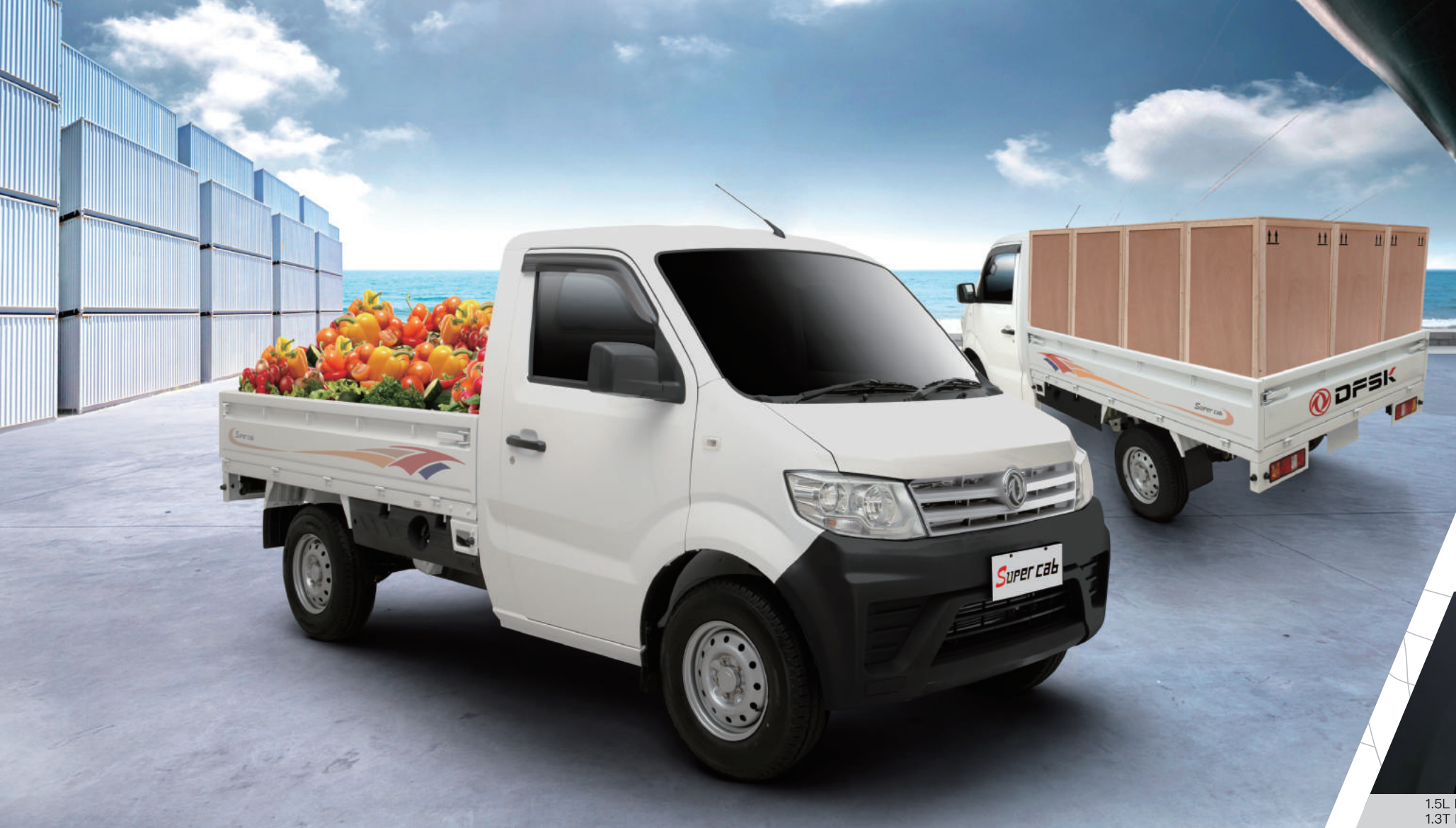
Enam bar Upper Leaf dengan ground clearance yang lebih tinggi agar dapat akses dengan baik di berbagai kondisi jalan
